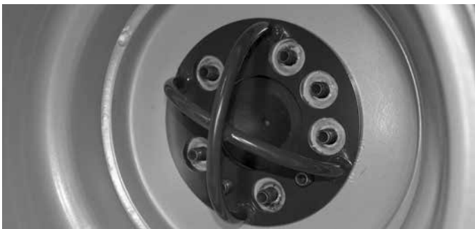
Halterung auf Radnabe A423091
