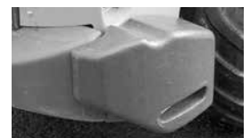
Seitliches Heckgewicht: (2 × 90 kg)
