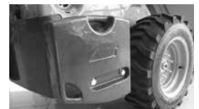
Seitliches Heckgewicht: (2 × 40 kg)
