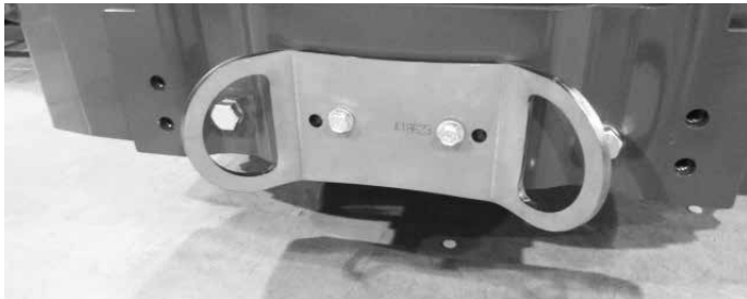
Zurrpunkthalterung A418623 am hinteren Stoßfänger oder Zusatzgewicht installiert
