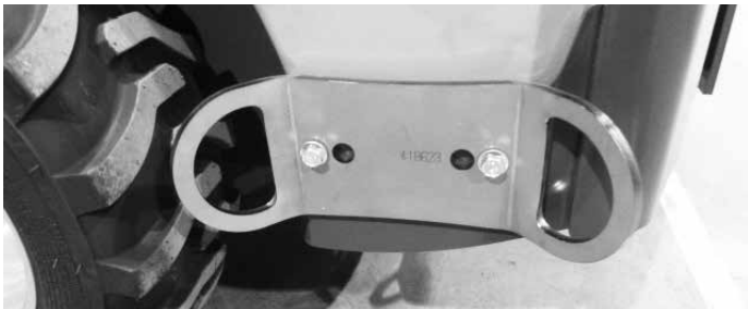
Zurrpunkthalterung A418623 seitlich am Hinterwagen installiert. Für die seitliche Montage sind zwei Halterungen erforderlich.
